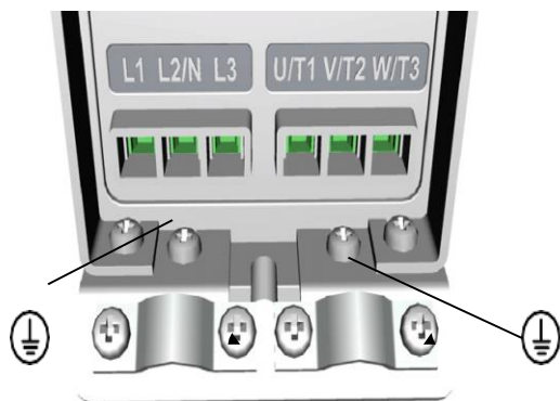
Рисунок 5: Присоединение заземления (PE) к клемме защитного заземления Vacon 20
