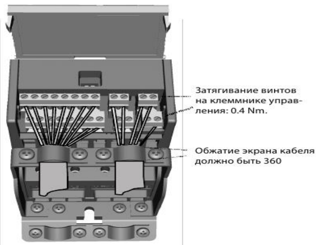
Рисунок 9: Подключение кабелей управления Vascon 20 корпуса MI1-MI3
