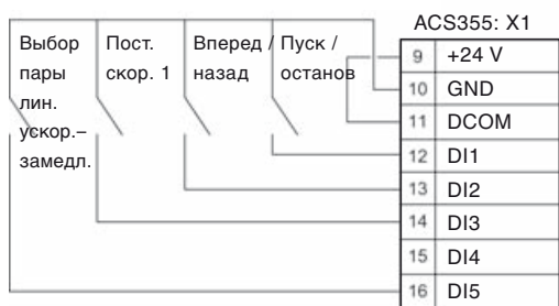
Конфигурация цифровых входов (DI) (подключение PNP) (приемник)
