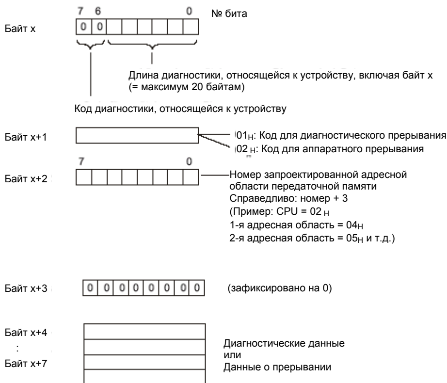
Рис. 5-4. Структура диагностики, относящейся к устройству
